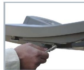
4. 用17扳手固定电子表架。
