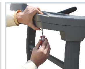
6. 用螺丝刀装上左右上护套。
