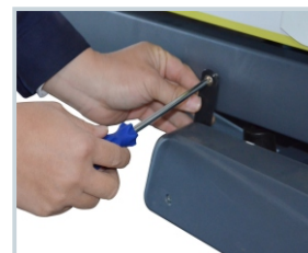
10. 将右侧边与跑台连接的保险铁片用十字螺丝刀松下来。
