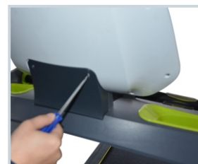
7. 用十字螺丝刀将后护壳用螺丝固定。
