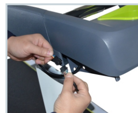
4. 立柱线与表架线按图中要求对接上。
